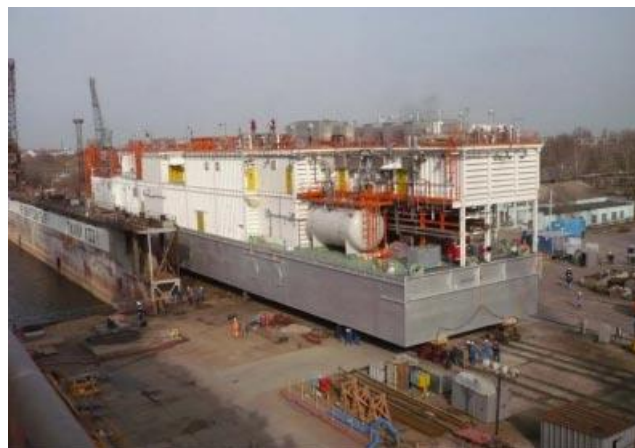
Спусковой вес модуля — 3 600 тн
